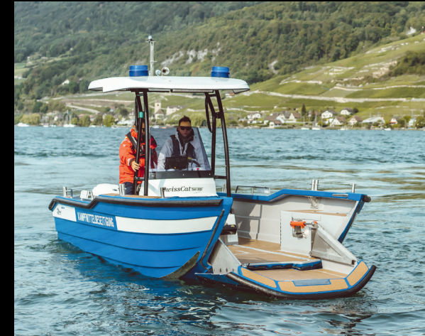
Die patentierte Bugklappe über der Wasserlinie erleichtert jegliches Retten und Bergen.
